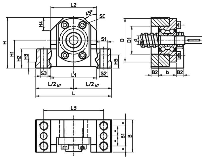
Подшипниковая стойка как фиксированная опора
