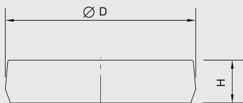
Таблица 1.17: Крышка для крепежных отверстий профильных направляющих
