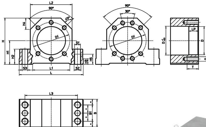
Корпус для фланцевых гаек по DIN 69051 часть 5
