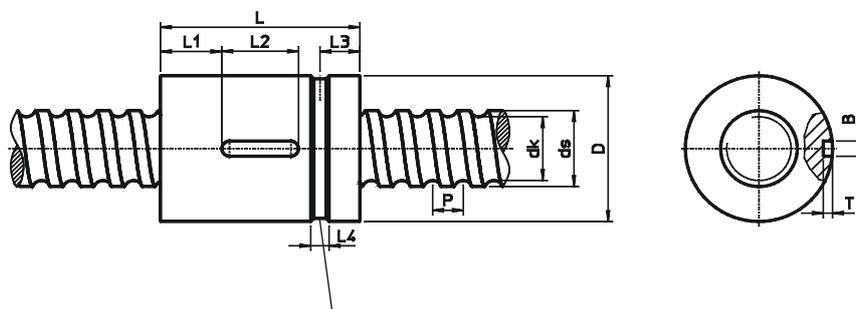
Канавка для долива смазочного материала
