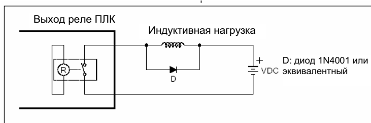
Подавление выбросов напряжения в цепи постоянного тока диодом (при низкой мощности)
