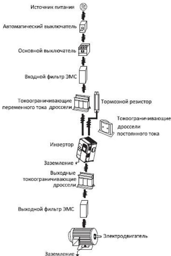
Рис. 3-2 Схема подключения периферийных устройств
