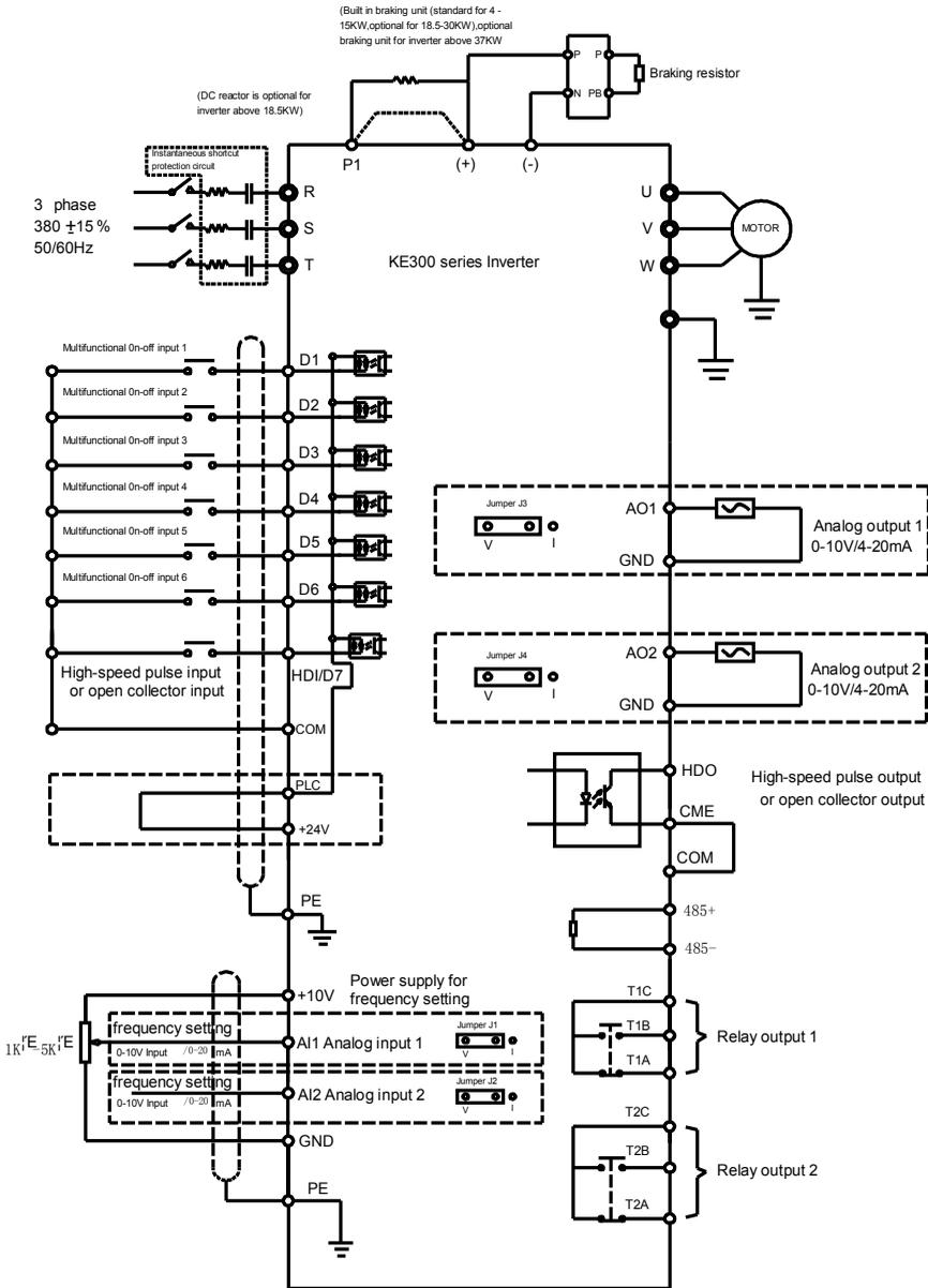
Figure 3-4 Wiring Diagram (> 1.5kW)
