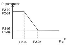
Figure 6-2 PI parameter diagram
