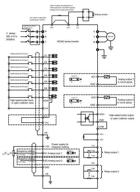
Figure 3-4 Wiring Diagram (> 1.5kW)
