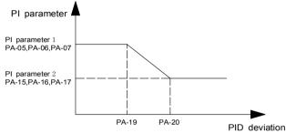
Figure 6-25 PID parameter switching diagram
