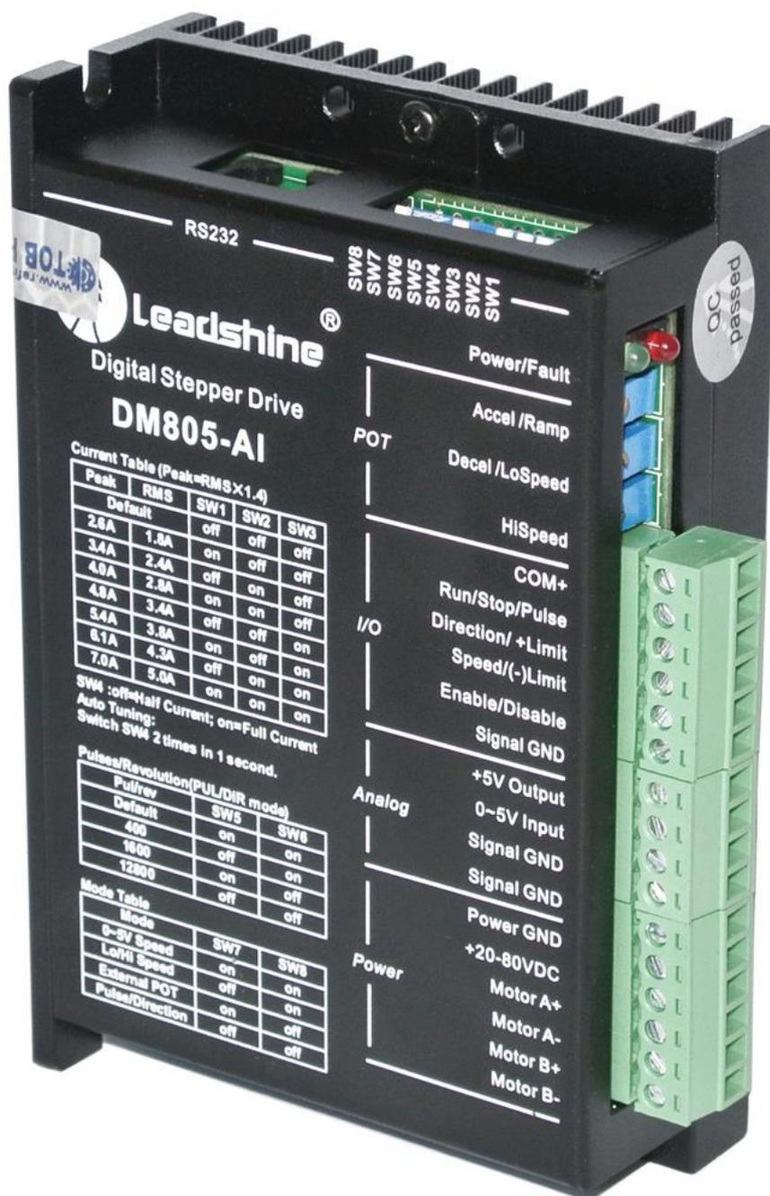
Цифровой драйвер шагового двигателя со встроенным генератором импульсов для управления скоростью
