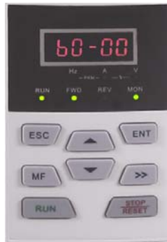
Fig. 4-9 First-tier display of parameter
