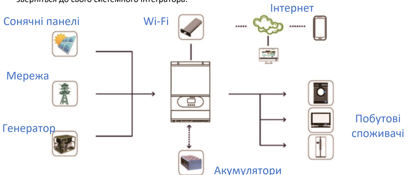
Малюнок 1. Гібридна система живлення
